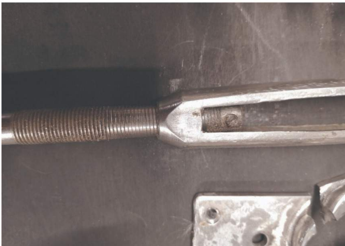
Wantenspanner: Reinigen und neu fetten, auf Defekte, wie hier am Gewinde, prüfen. Bei Schäden die Teile unbedingt austauschen
