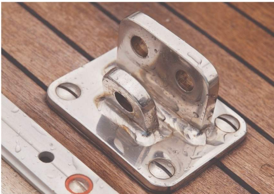
Edelstahl polieren: Damit sich auf rauen Oberflächen kein Flugrost festsetzt, sollten alle Edelstahlteile an Deck regelmäßig poliert werden
