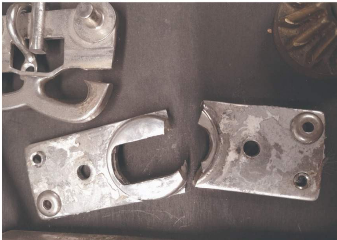
Beschläge: Besonders die Halteplatten der Terminals kontrollieren. Brechen oder lösen sie sich, kann der Mast von oben kommen
