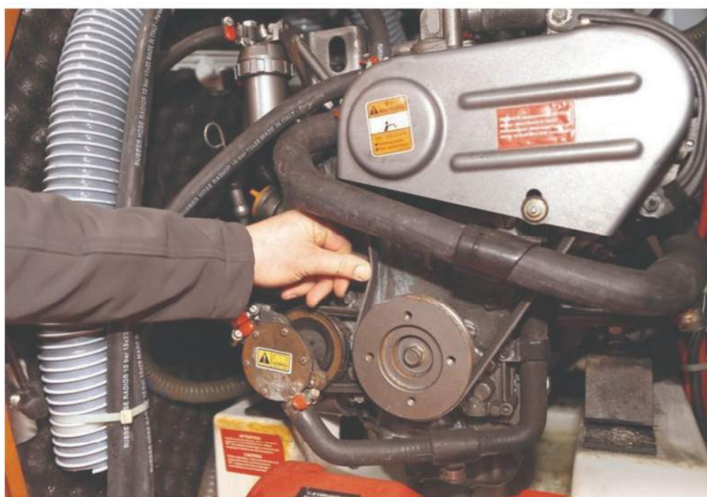
Per Druck- oder Verdrehtest die richtige Spannung der Keil- oder Zahnriemen kontrollieren
