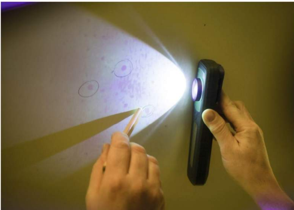
Auf Osmose prüfen: Per Streiflicht lassen sich Osmoseblasen erkennen, am besten im Herbst. Sind sie zu sehen, einen Fachmann konsultieren
