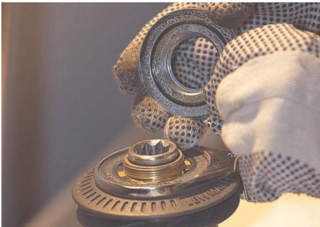
Winschen: Trommel und Getriebeteile reinigen und neu einfetten
