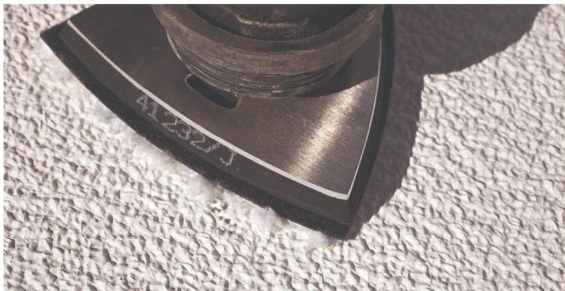
Antirutsch-Belag reinigen: Auf keinen Fall mit Hochdruckreiniger! Spezielle Vliese für Oszillationsschleifer können helfen, ansonsten schrubben
